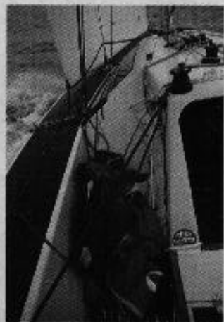
Cockpittet i Archi'en er ført frem langs nedgangen til kahytten. Her til læ kunne spileren ligge parallel med skæder og fald på. Læg mærke til at genuaens skædeskinne er tværstillet, så skædepunktet kan flyttes ud og ind.
