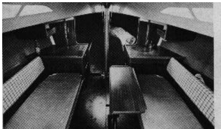
X-79 er sparsomt apteret. Køjerne i kahytten og forrummet er rørkøjer med lærred (vejer meget lidt). Pantryet er placeret fremme ved masten, hvor pladsen er lidt trang. Det havde været bedre med pantryet ved nedgangen.
